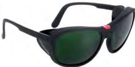
Lenti verdi iR5 in policarbonato con trattamento antigraffio intercambiabili, occhiale bilente con protezioni laterali areate basculanti, vite centrale per una veloce sostituzione delle lenti.
