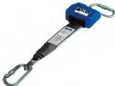
Dispositivo anticaduta retrattile a nastro in poliestere da 48 mm e lungo 2,5 m, con 2 moschettoni a vite M100 in acciaio galvanizzato apertura 18 mm, con assorbitore di energia integrato.
