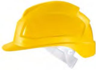
Adatto per attività di elettricisti, il casco è completamente privo di aperture. Predisposizione aggancio per sistemi di visiere cuffie e lampade. Fornisce protezione a temperature estremamente basse (-30° C). MM = Resistenza a metallo fuso (spruzzi). Certificato secondo la norma EN 50365 (1000 V AC). Sospensione interna in tessuto a 6 cardini, ampia fascia antisudore per una stabilità maggiore. Regolazione: tg. 51-61 cm.
