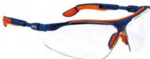
Monolente chiara con trattamento Supravision Excellence in policarbonato antigraffio all'esterno e antiappannante all'interno, eccellente protezione laterale e protezione sopraccigliare assorbiti-urti, protezione dai raggi UV 400, stanghette Quattroflex in policarbonato e gomma, morbide, flessibili e regolabili in inclinazione e lunghezza, ventilazione indiretta, ampio campo visivo.
