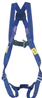
Imbracatura a 2 punti di ancoraggio dorsale e sternale, in tessuto poliestere di lunga durata, anello a D dorsale in acciaio galvanizzato completamente scorrevole per un maggior confort, nastro sub-pelvico per ulteriore confort e sicurezza, fibbie accoppiate su petto e gambe, nastro pettorale da 45 mm in poliammide con fibbia metallica ad apertura rapida. Peso 600 g.
