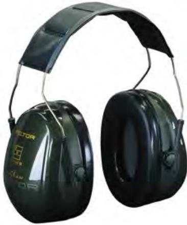
Bardatura temporale, studiata appositamente per ambienti molto rumorosi, massima attenuazione anche alle basse frequenze, gli ampi cuscinetti sono imbottiti con un'esclusiva combinazione di liquido e schiuma che fornisce una tenuta ottimale e massimo confort anche per usi prolungati, peso 210 g.
