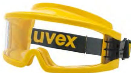
Lente chiara in policarbonato ad alta resistenza meccanica, antiappannante all'interno con trattamento Supravision Excellence e antigraffio all'esterno, a tenuta di gas, protezione dai raggi UV 400, bardatura elastica regolabile, priva di ventilazione per essere utilizzata anche in presenza di gas, vapori e fumi.
