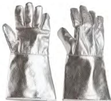
Palmo e dorso in fibra aramidica alluminizzata spessore 1,1 mm, foderati in TNT ignifugo 0,7 mm, manichetta in tessuto aramidico alluminizzato foderato in TNT ignifugo, cuciture con filo di Kevlar.
