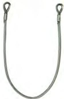
Cavo di ancoraggio in acciaio zincato da 6.3 mm con guaina protettiva in plastica, carico di rottura elevato >15 KN, apertura grande per l'ancoraggio a travi e putrelle, lunghezza 1 m.
