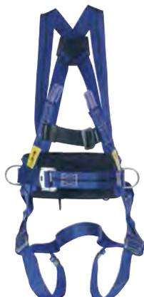
Imbracatura a 2 punti di ancoraggio dorsale e sternale con cintura di posizionamento, in tessuto poliestere di lunga durata, anello a D dorsale in acciaio galvanizzato completamente scorrevole per un maggiore confort, nastro sub-pelvico per ulteriore confort e sicurezza, fibbie accoppiate su petto e gambe, nastro pettorale da 45 mm in poliammide con fibbia metallica ad apertura rapida. Peso 1 Kg.
