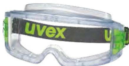
Lente chiara in policarbonato con trattamento Supravision Excellence antigraffio all'esterno e antiappannante all'interno, conforme ai requisiti medi di resistenza meccanica (classe B 120 M/S), idoneo ad essere indossato sopra occhiali correttivi, protezione contro i raggi UV 400, bardatura elastica regolabile.
