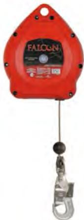
Cavo in acciaio galvanizzato diametro 4.8 mm, con Carter in plastica composita, praticamente indistruttibile, altamente resistente agli urti ed alle applicazioni più dure e impegnative, la forma arrotondata ne aumenta la durata. Il meccanismo di bloccaggio ad attivazione rapida limita la caduta in pochi centimetri permettendo un arresto veloce. Un indicatore di caduta ben visibile indica chiaramente quando è necessario rimuovere il dispositivo.
